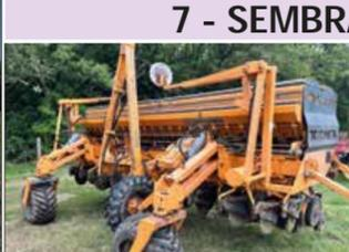
**Agrometal MX 23-21**, año 2001, doble fertilización, cajón alfalfero, monitor de rotación de ejes.-
