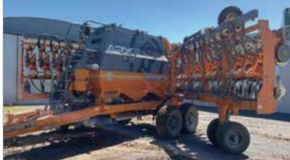
**Agrometal APX 27 a 42 cm.**, neumática, año 2017, monitor Plantium (semilla por metro, mapea, obstrucciones de semillas y fertilizante), cuerpos con pistones presurizados (regula de cabina).-
