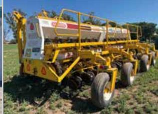
**Ascanelli Magnun RS3000 de 12 a 52,5 cm.** a placa, fertilización en línea o al costado, monitor Agrotax, reparada íntegra en 2024
