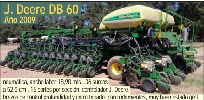
neumática, ancho labor 18,90 mts., 36 surcos a 52,5 cm., 16 cortes por sección, controlador J. Deere, brazos de control profundidad y carro tapador con rodamientos, muy buen estado gral.
